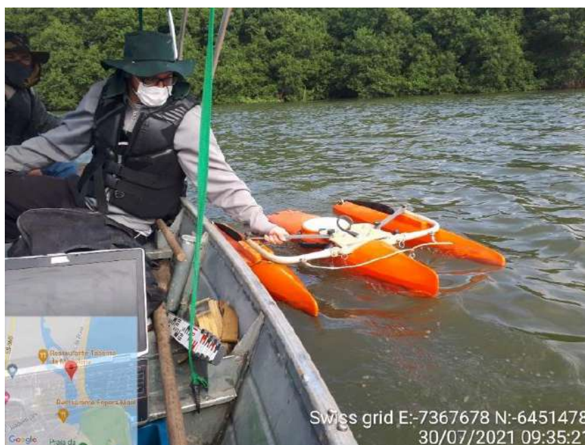
Figura 68 - Procedimento de coleta de dados de vazão na região estuarina do rio Jucu, durante maré de quadratura.
