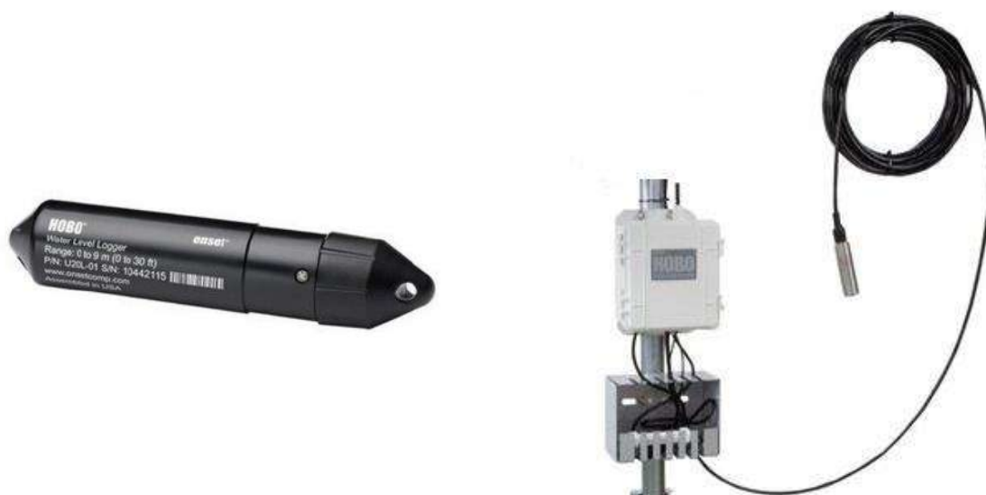
Figura 63: Marégrafos de um sensor a esquerda e marégrafo de dois sensores à direita.
