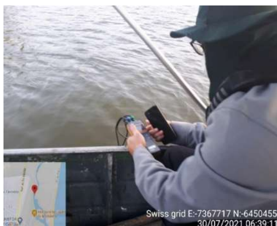
Figura 71 - Procedimento de mensuração de salinidade da água in loco, na região estuarina do rio Jucu, referente a maré de quadratura.
