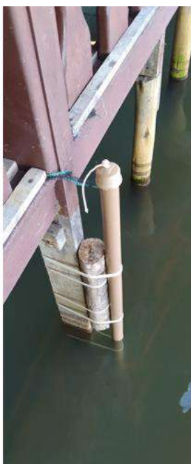
Figura 66 - Instalação de marégrafo na porção de jusante do Rio Jucu.
