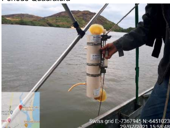
Figura 41 - Garrafa de Van Dorn utilizada para as coletas de água - Período Quadratura
