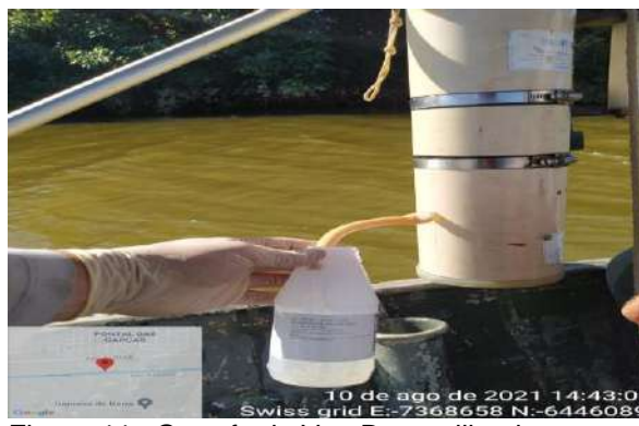
Figura 44 - Garrafa de Van Dorn utilizada para as coletas de água
