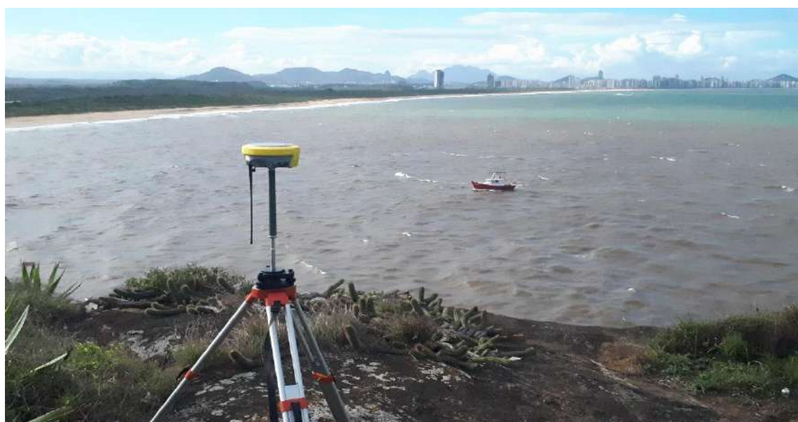
Figura 59 - Procedimentos de realização de batimetria na região costeira próxima a foz do rio Jucu.
