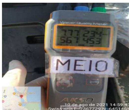
Figura 72 - Procedimento de mensuração de salinidade da água in loco, na região estuarina do rio Jucu, referente a maré de sizígia.
