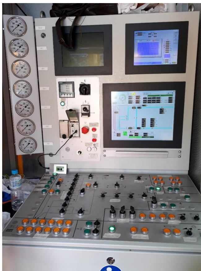
Figura 91 – Equipamento de monitoração remota da cravação.
